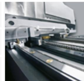
Höchste Präzision: Glasmaßstäbe und digitale Antriebstechnik ermöglichen höchste Beschleunigungen bei gleichermaßen hoher Konturtreue.
