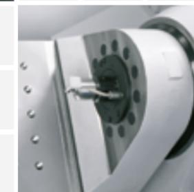
**Stationäres 3D-Tastsystem TS 27** zur Werkzeugvermessung, Werkzeugbruchkontrolle sowie Maschinenkompensation.
