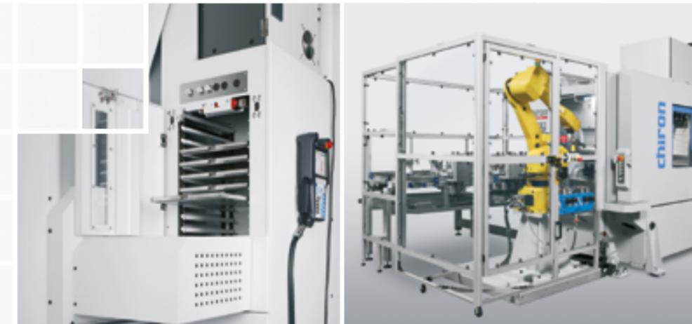
Palettenpeicher für max. 12 Rohteilpaletten (400 x 600 mm) im Abstand von 45 mm. Bei größeren Werkstücken reduziert sich die Palettenanzahl. Die Paletten für Roh- und Fertigteile lassen sich jederzeit hauptzeitparallel austauschen.
