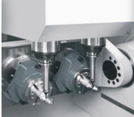
Der Multiplikator-Effekt – mehr Spindeln, mehr Schneiden, mehr Profit: Die Kombination von 2 Spindeln und einer 4-fach Spannvorrichtung ergibt eine Kosteneinsparung von bis zu 50 %. Doppelte Produktivität auf einer Maschine bedeutet eine Reduzierung der Bearbeitungszeit auf nahezu 50 %. Zudem besteht die Möglichkeit der Mehrseitenbearbeitung durch eine NC-gesteuerte Rundachse.
