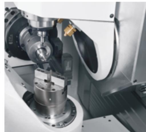
Der modulare Aufbau der FZ08 MT ermöglicht die kundenspezifische Konfiguration für den vielfältigen Einsatz in zahlreichen Branchen. Das MT-Fertigungs-zentrum ist mit dem neuen CHIRON Schwenkkopf mit Torqueantrieb für höhere Präzision und Oberflächengenauigkeit ausgestattet.
