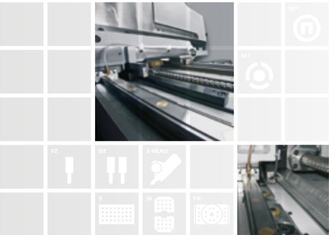
Höchste Präzision: Glasmaßstäbe, digitale Antriebstechnik und absolute Wegmesssysteme ermöglichen hohe Beschleunigungen bei gleichermaßen hoher Konturtreue.
