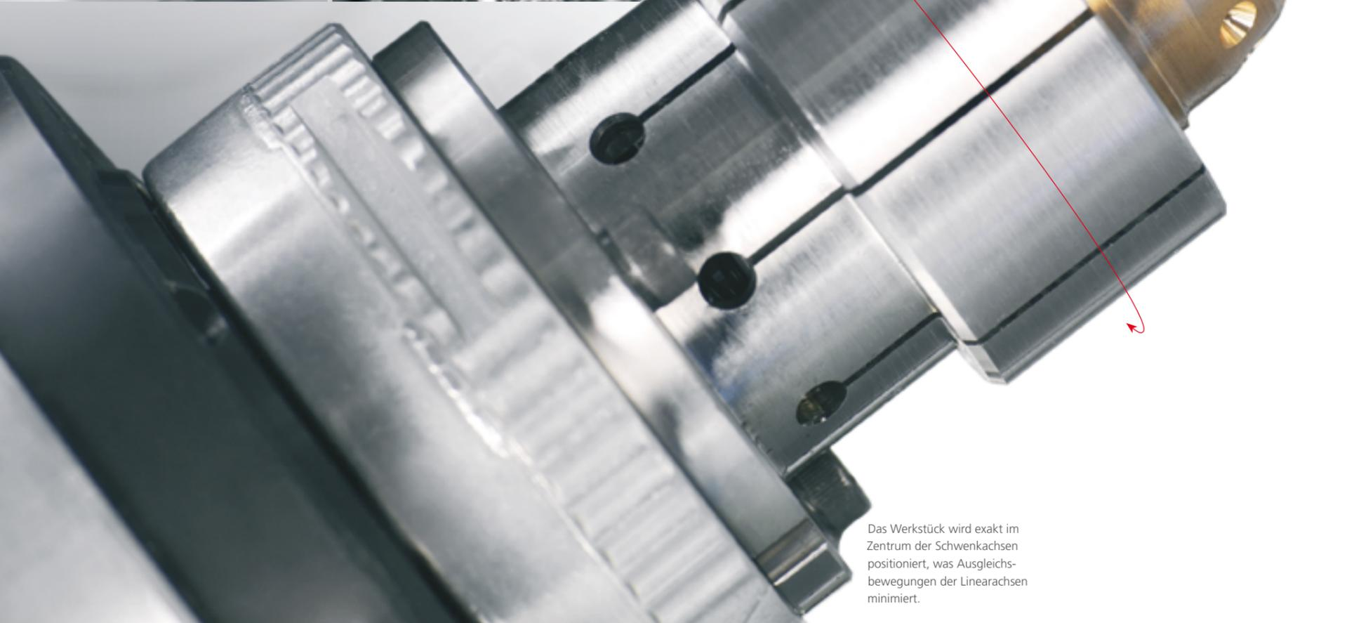
Das Werkstück wird exakt im Zentrum der Schwenkachsen positioniert, was Ausgleichsbewegungen der Linearachsen minimiert.
