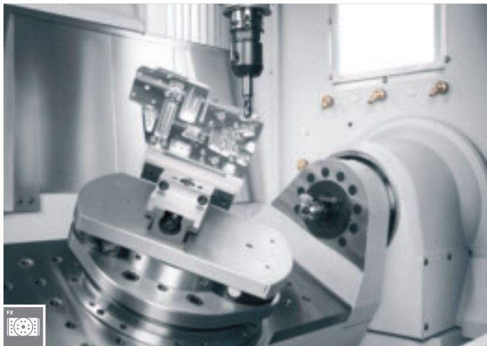
2-Achs-Schwenkrundtisch für die wirtschaftliche Fünfachs-Komplettbearbeitung. Werkstück-Dimension: max. Ø 610 x 200 mm / Störkreis: Ø 650 mm
